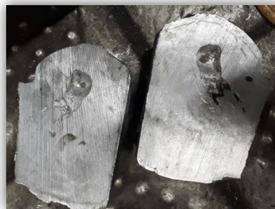
Раковина в стальной отливке, «новая» модель (ООО «СМЗ»)
